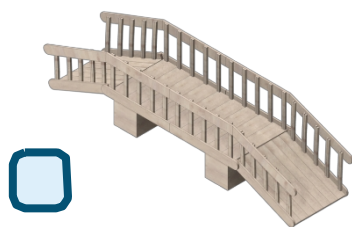
Puente de vigas
